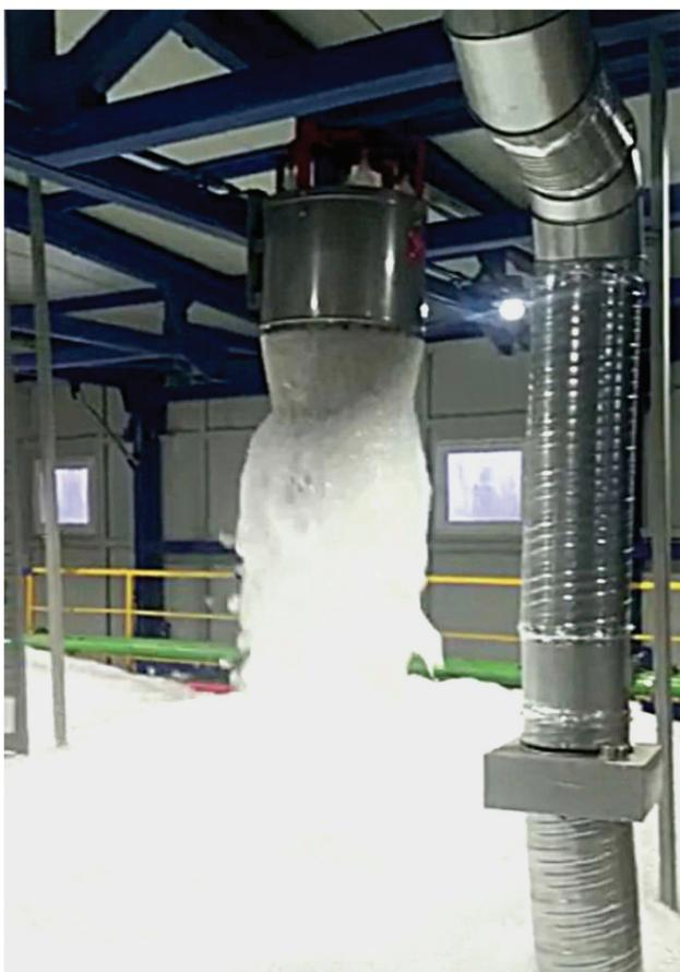
Эжекторный генератор высокочастотной пены
